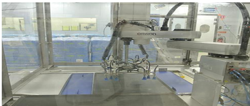
Рисунок 2 – Роботизированная рука Omron для производства макаронных изделий
