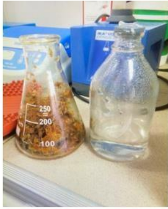
Тепе-теңлік перапет кышкылынын сулы ертіндісі аркылы делигнификация
