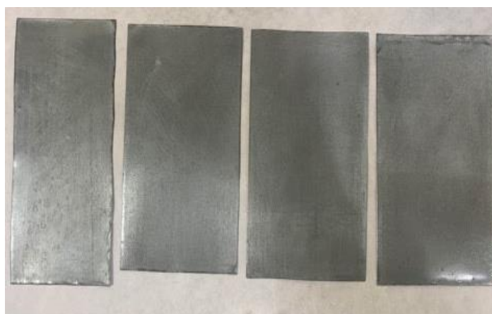
Рисунок 38 – Образцы покрытия на основе эпоксидной смолы после выдержки в бензине в течение 24 часов с добавками микросфер
