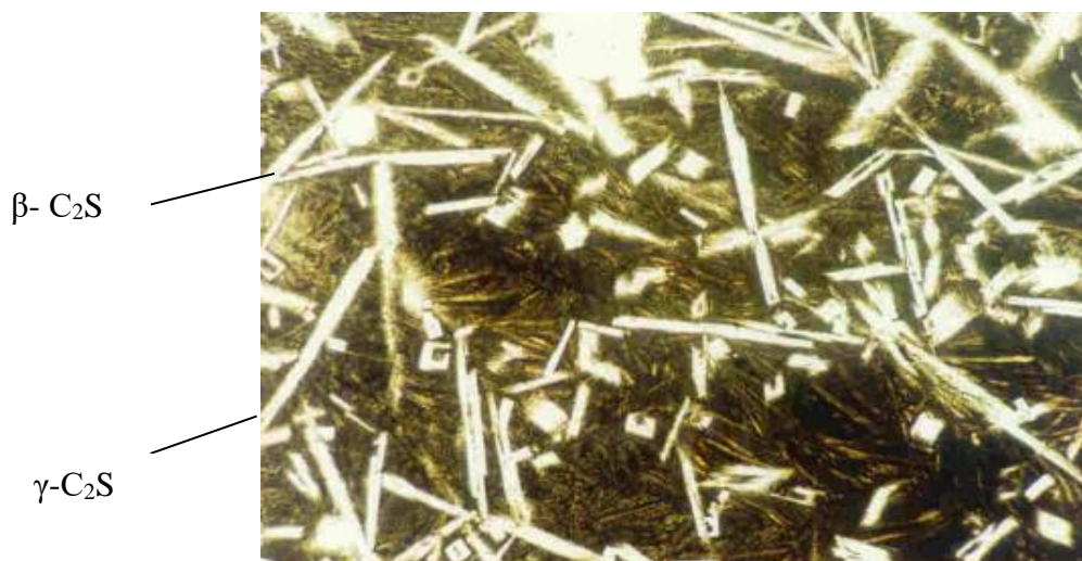
Рисунок 42 – Микроструктура конверторного шлака обожженного при T=1000^\circ\text{C}
