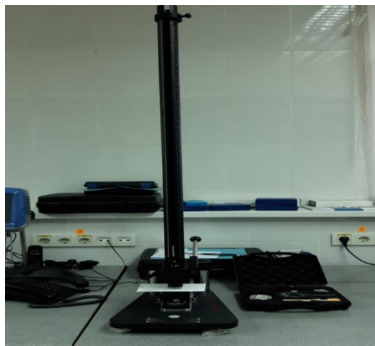
Рисунок 3 – Прибор BGD 305 Tubular Impact tester
