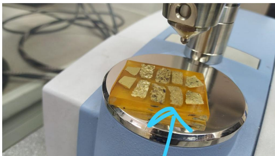
Рисунок 53 – ИК-спектральный анализ образцов
