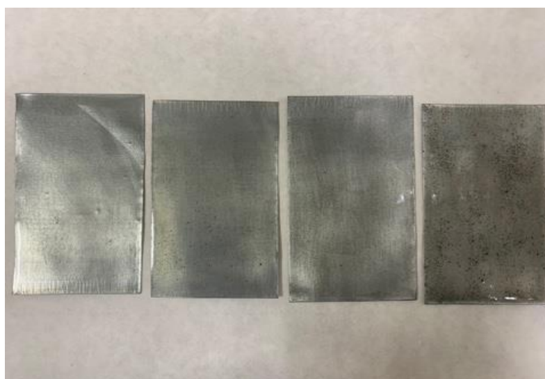
Рисунок 21 – Образцы покрытия на основе эпоксидной смолы после воздействия переменных температур в течении 60 мин с добавками микрокремнезема (с лева направо 0, 2, 5, 10%)
