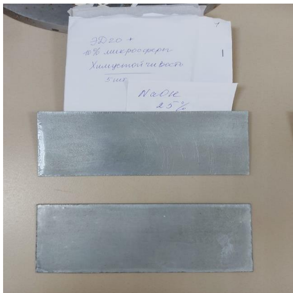
Рисунок 35 – Образцы покрытия на основе эпоксидной смолы с добавками 10 % микросфер после выдержки в 25% растворе \text{NaOH} в течение 24 часов в сравнении с контрольным образцом
