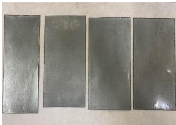
Рисунок 37 – Образцы покрытия на основе эпоксидной смолы после выдержки в 25% растворе H_2SO_4 в течение 24 часов с добавками микросфер
