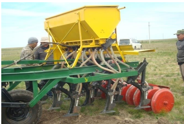
Рис. 1 - Экспериментальный образец стерневой зернотуковой сеялки с раздельным внесением семян и удобрений перед работой.
