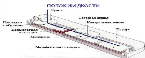
Рис. 1 – Схема устройства иммунохроматографического теста
