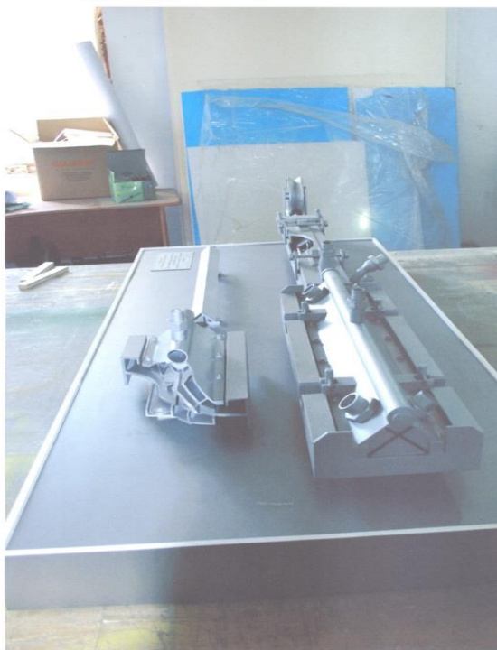
Рис. 1 –Макет установки интенсивного и регулируемого охлаждения сортового проката
