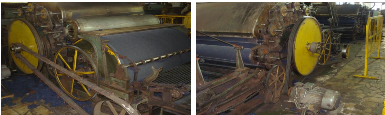
Рис.1 - Общий вид главного барабана и рабочих валиков многопрочесных чесальных аппаратов
