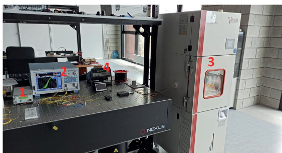
Рисунок 1 - Система для измерения влияния температуры на спектральные характеристики косых решеток Брэгга
