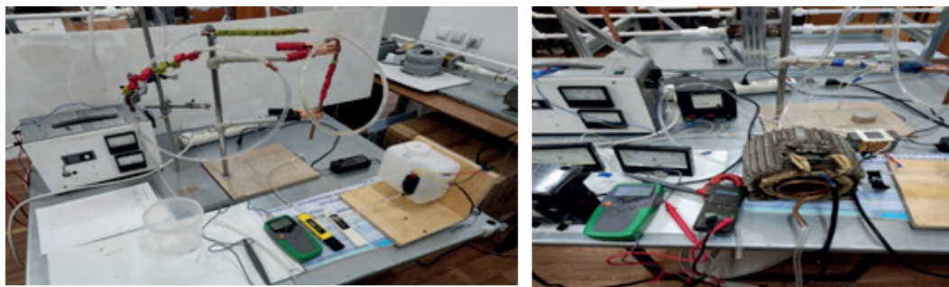
1 сурет - Суды магниттік өңдеу параметрлерін өлшеу үшін қолданылатын зертханалық стенд және аспаптар
