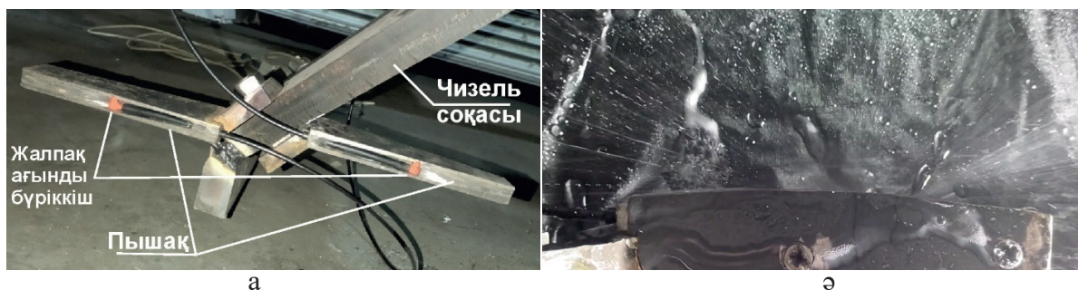
2 сурет - Топырақ өңдеу пышағы және бүріккіш
