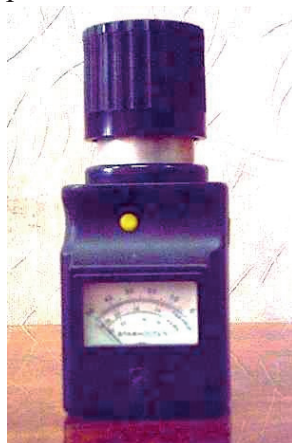
5 сурет – Ылғалдылықты өлшейтін ММ-2R аспабы
