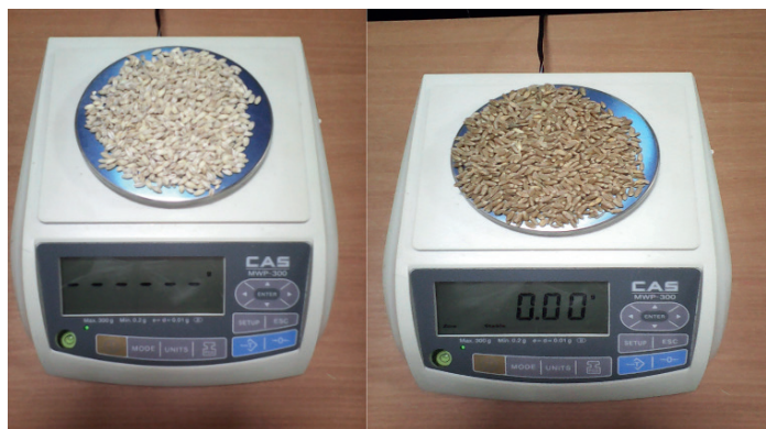
3 сурет – Дәнді дақылдардың 1000 дәнінің салмағын таразымен өлшеу
