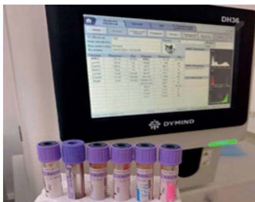
1 сурет – «Love Animals» - DH36 Vet ветеринарлық емдеу – диагностикалау орталығында орналасқан ветеринарлық зерттеу гематологиялық анализаторлар
