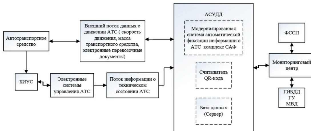
Рисунок 3 – Схема взаимодействия БИУС ТС с информационно-аналитическим комплексом посредством матричного QR кода
