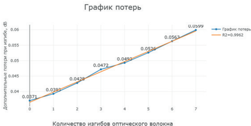
Рисунок 2 – График зависимости роста дополнительных потерь при увеличении количества изгибов ОВ при длине волны 1310 нм
