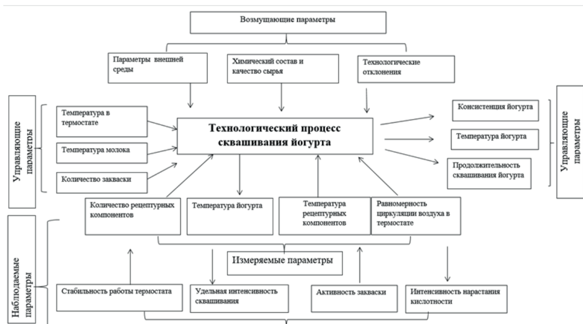
Рис 1. Параметрическая схема технологического процесса сквашивания йогурта
