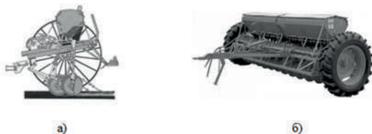
Сурет 2. СУ - 24 астық себуші құрылғысы (а) және әмбебап СЗ - 3,6 сепкіші(б)
