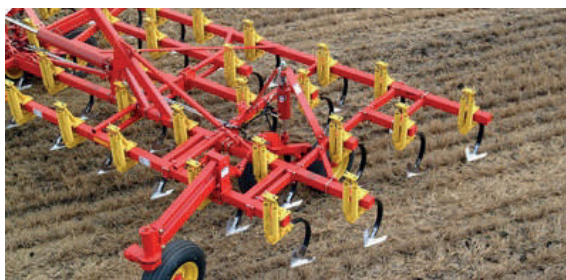
б – Рама посевного комплекса культиваторного типа Bourgault 8910
