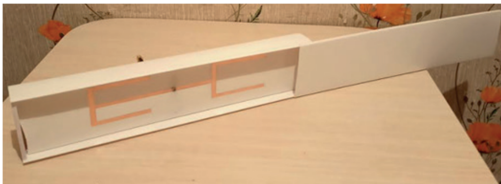
Рис. 4 - Прототип микрополосковой антенны с частотой 868 МГц
