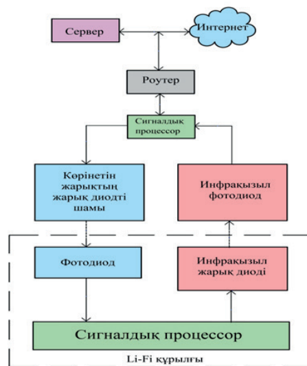
1 сурет - Екі жақты мәліметтер тарататын Li-Fi байланыс жүйесінің құрылымдық сұлбасы
