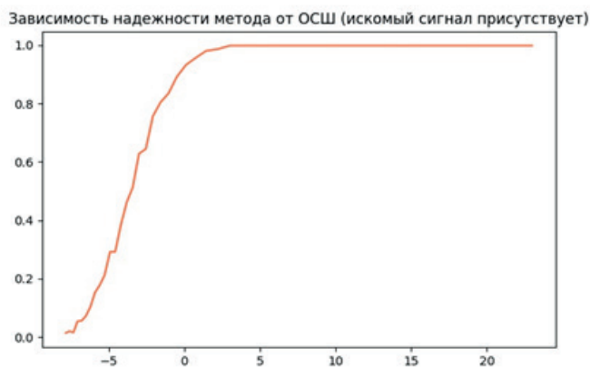
Рис. 5 - Зависимость надежности метода от уровня шума при наличии искомого сигнала в измеренном сигнале
