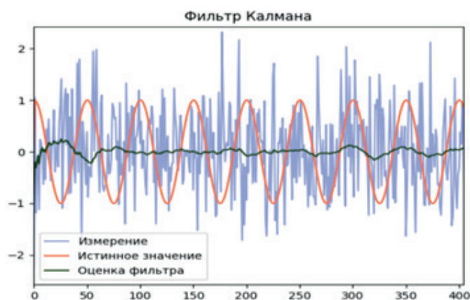
Рис. 3 - Результат работы фильтра Калмана при отсутствии искомого сигнала на входе фильтра
