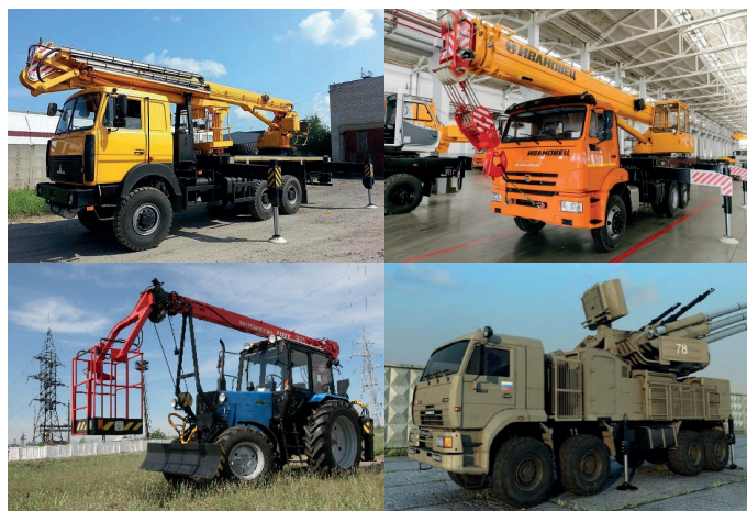
Рисунок 2 – Применение выносных опор в различной специализированной технике.
