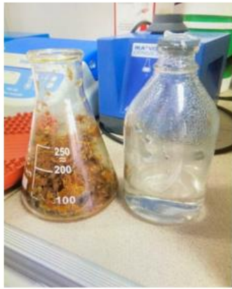
Тепе-теңдік перацет қышқылының сулы ерітіндісі арқылы делигнификация
