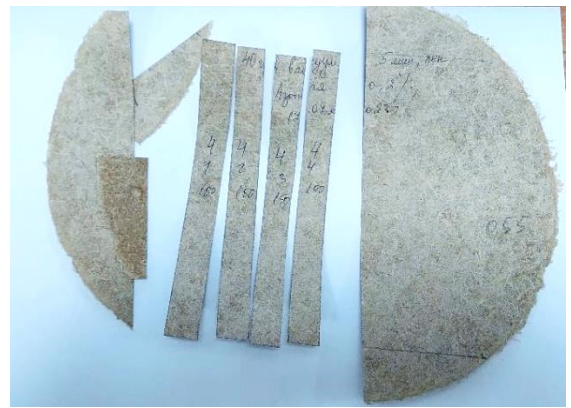
Сурет 43 - Үзілуге сыналатын қағаз үлгілері
