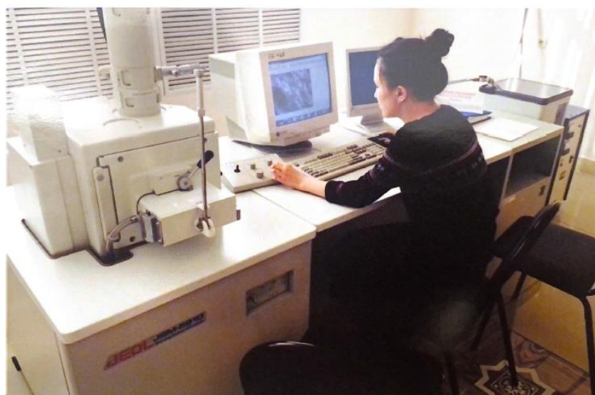
Рисунок 12 – Процесс работы с электронным сканирующим микроскопом JEOL 5910
