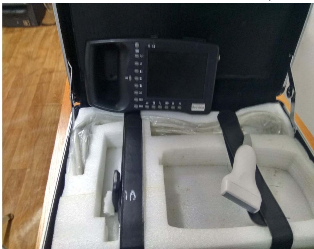
УЗИ для определения зрелости икры осетровых рыб
