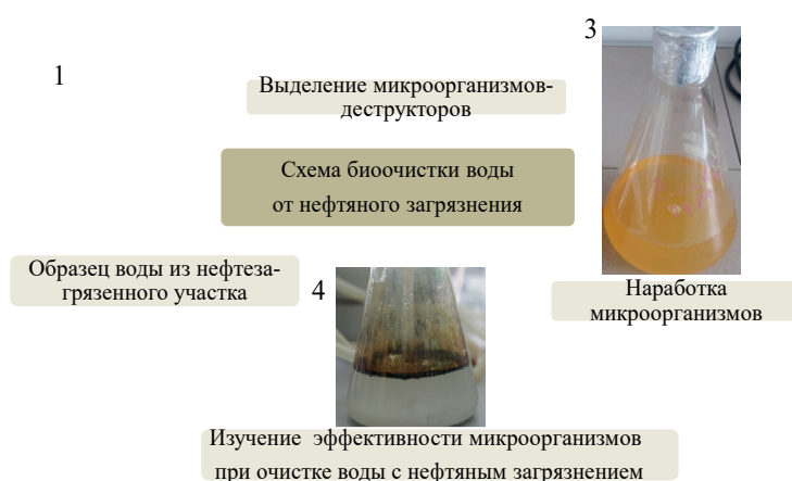
Рисунок 1 – Схема биоочистки воды от нефтяного загрязнения с использованием выделенных микроорганизмов
