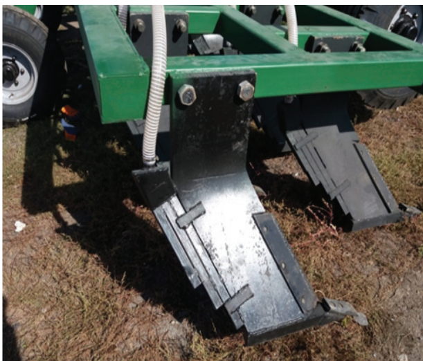
Рисунок 2 – Рабочий орган с распределителем
